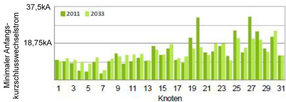
Bild 6-2: Vergleich des minimalen Kurzschlussstroms im Jahr 2011 und 2033 [43]
