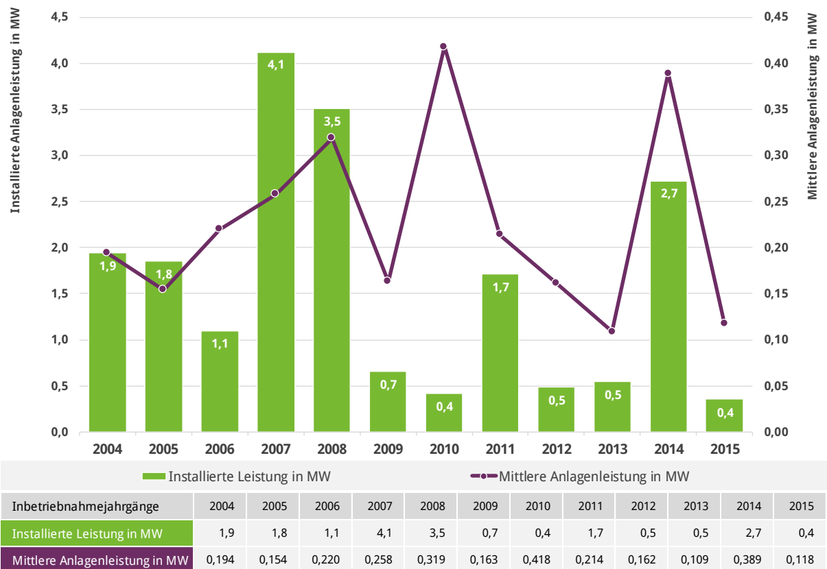
Abbildung 14 Entwicklung von Gesamtzubau und mittlerer Anlagengröße für Klärgas seit 2004
